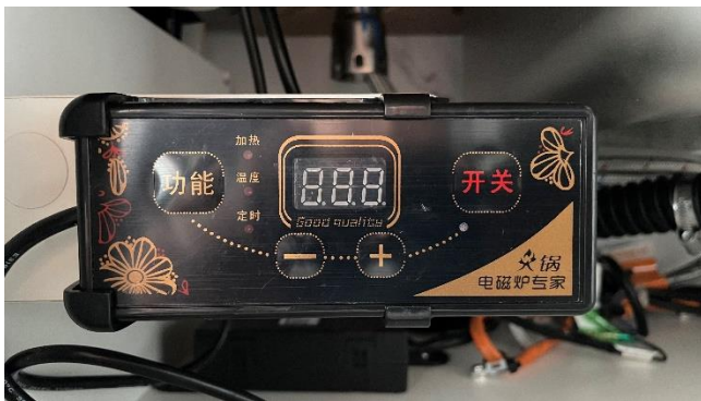
电磁炉开关控制面板
