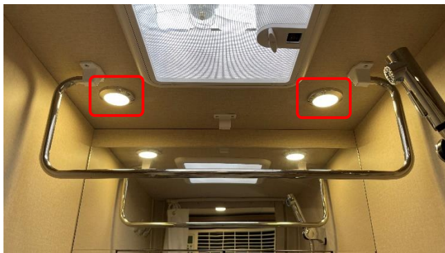
阅读灯：由阅读灯底座中间的触摸开关控制。
