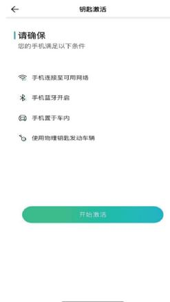
快捷入口：打开“上汽MAXUS”APP，点击爱车<sup>爱车</sup>界面中的左上角蓝牙未激活图标<sup>未激活</sup>，跳出上述步骤三界面，点击开始激活，根据手机提示进行激活，激活成功，车主即可畅享本款无感蓝牙钥匙所有功能。
