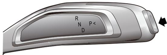
车辆静止时，按压P挡按钮（1），车辆进入P挡。
