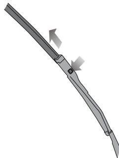
前刮水器刮片更换前需要将前刮水器开关调整至维修功能。
