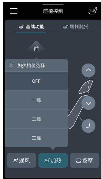
您也可以进入中控屏上的空调界面进行调节。座椅加热功能有3档，进入空调界面，选择左侧/右侧加热触摸按键，依据提示分别对第二排左/右侧座椅的加热功能进行调节。
