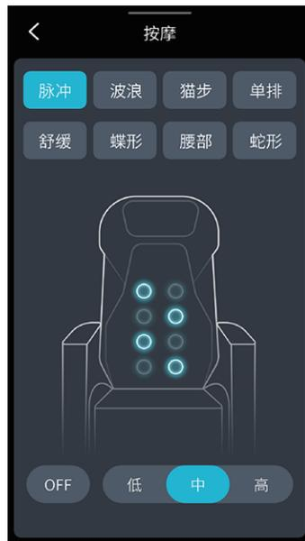
您也可以进入椅背屏操作界面：车控->座椅->座椅按摩进行调节。座椅按摩功能有8种模式3档调节，点击所需模式及档位进行的按摩调节。
